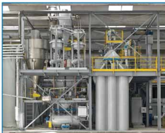
Linea per Coating Pet Food con Vacuum Mixer – Miscelatore Grassatore sottovuoto
